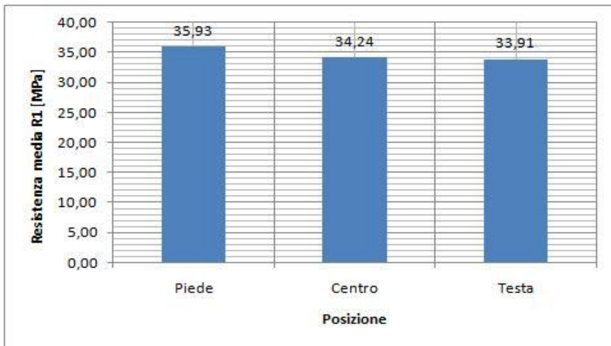
Figura 5.9 Resistenze medie nelle carote cappate in funzione della posizione.
