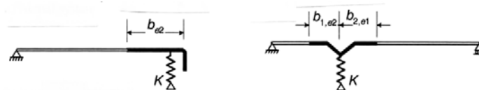
Figura C4.2.31 – Schematizzazione degli irrigidimenti
