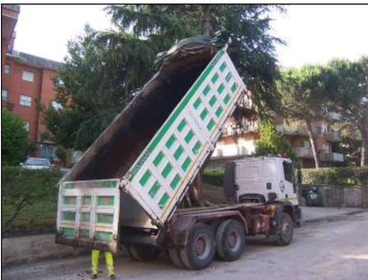
Figura 20 L'operatore ripulisce il vano di carico del mezzo che è stato utilizzato per trasportare il conglomerato.
