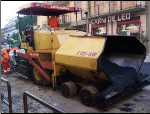
Figura 11 La macchina, anteriormente è in grado di ricevere una discreta quantità di materiale che viene convogliato per gravità e grazie ad un nastro trasportatore in acciaio, nella parte posteriore.
