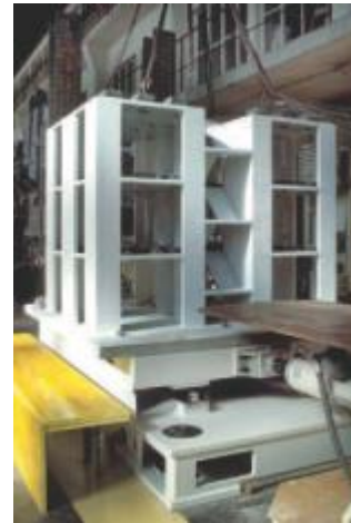
Modelli di edifici con struttura portante in muratura testati su tavola vibrante.
