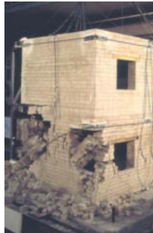
Modelli di edifici con struttura portante in muratura testati su tavola vibrante.
