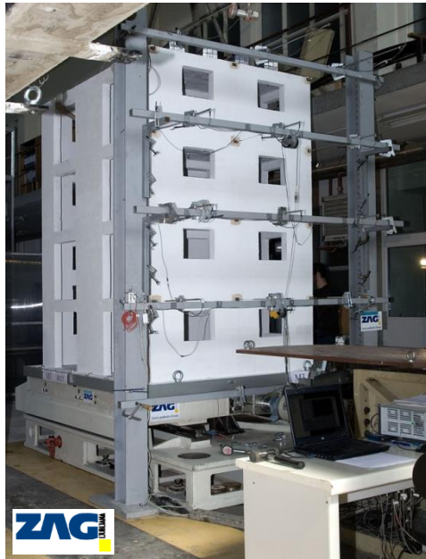
Vista assonometrica del modello M3 ( h = 2,65 m) e strumentazioni installate.
