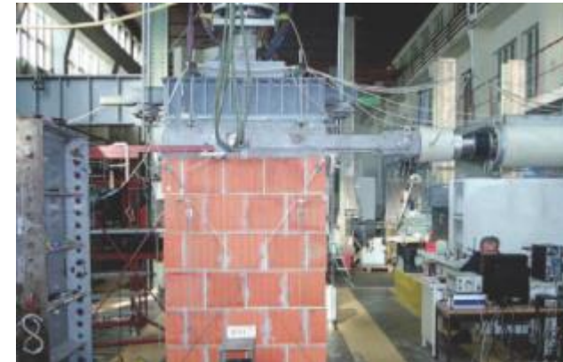
Pannello in muratura di mattoni forati durante il test a taglio ciclico .
