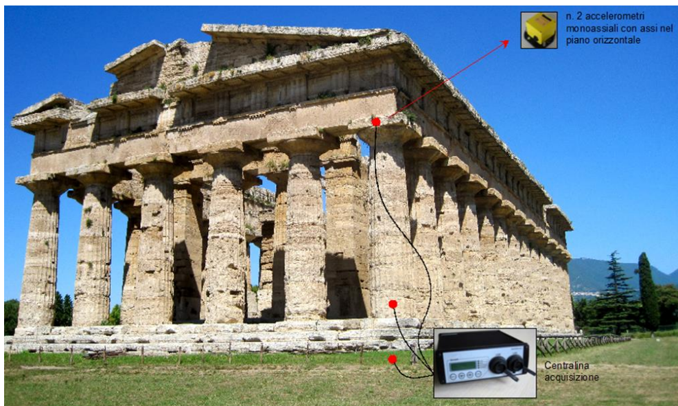
Fig. 2 - Strumentazione con sensori di accelerazione e centralina di raccolta dati del tempio di Nettuno (Paestum, SA).
